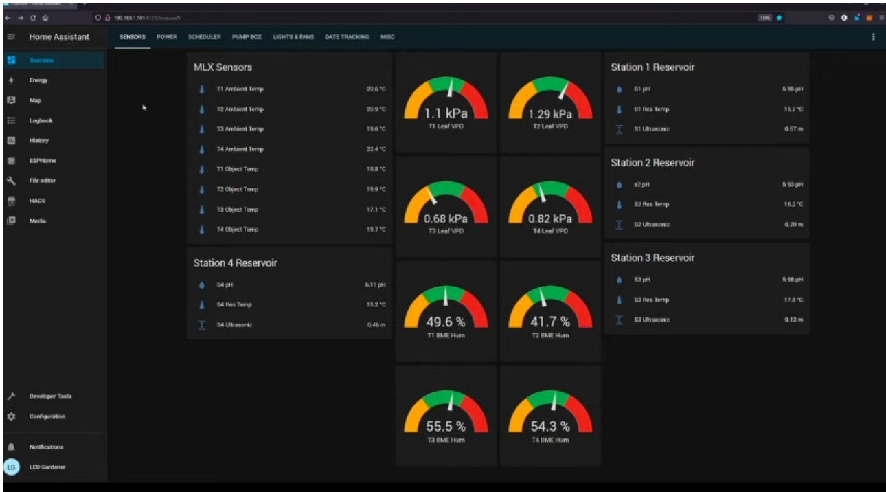
Afbeelding 49: Op dit dashboard zijn diagrammen voor VPD waarden toegevoegd, met bijbehorende kleuren om aan te geven of er binnen de juiste range gebleven is. Dashboard is gemaakt met de software Home Assistant zoals gebruikt door youtuber LED Gardener 8
