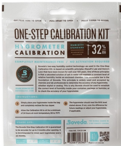
Afbeelding 28: Calibratiekits die kant en klaar te koop zijn. Deze van het merk Boveda zijn gemaakt om het meetpunt 75% en 32% te controleren.
