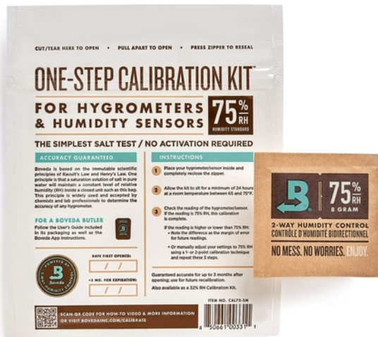
Afbeelding 28: Calibratiekits die kant en klaar te koop zijn. Deze van het merk Boveda zijn gemaakt om het meetpunt 75% en 32% te controleren.
